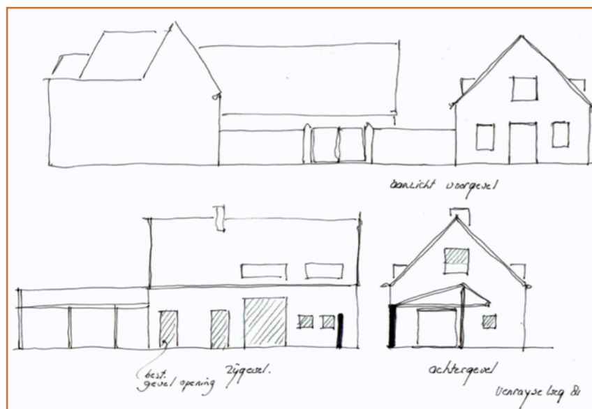
Afbeelding 15 (boven): Indicatieve schets van de gemeente voor behoud van de karakteristieke delen van de schuur na inpandige verbouwing tot woning.
