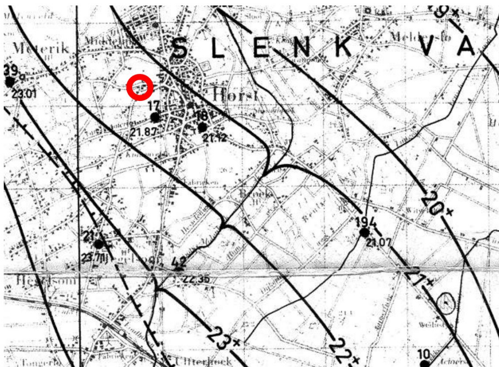
Figuur 7 Grondwaterkaart van Nederland voor het freatische pakket met in de rode cirkel de globale locatie van het projectgebied
