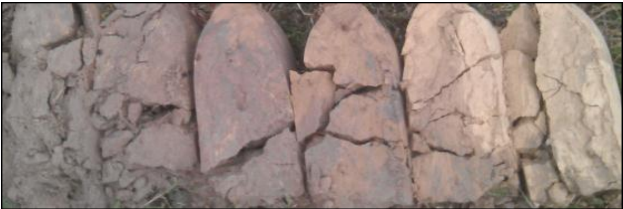
Figuur 10: boring 5: Een beigegrijs geroerd topdek op een beigegeel zandpakket met tussenin een mengzone met brokken
