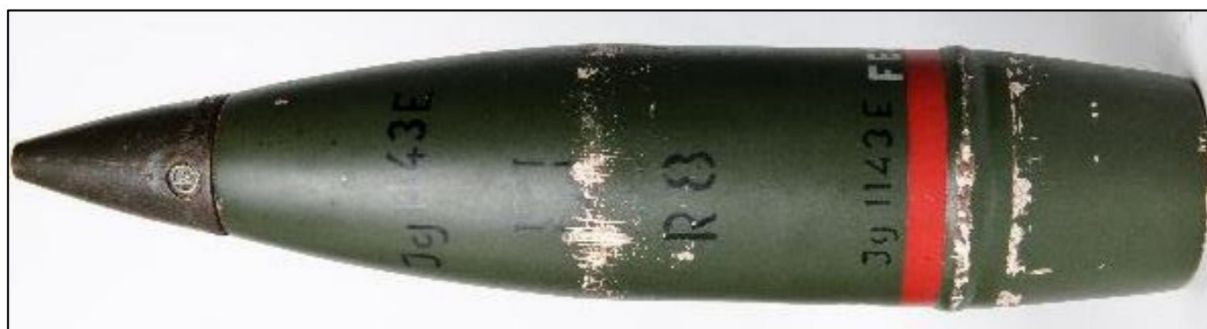
Afb.5 – Brisantgranaat van 10,5 cm met SB AZ23 (D).
