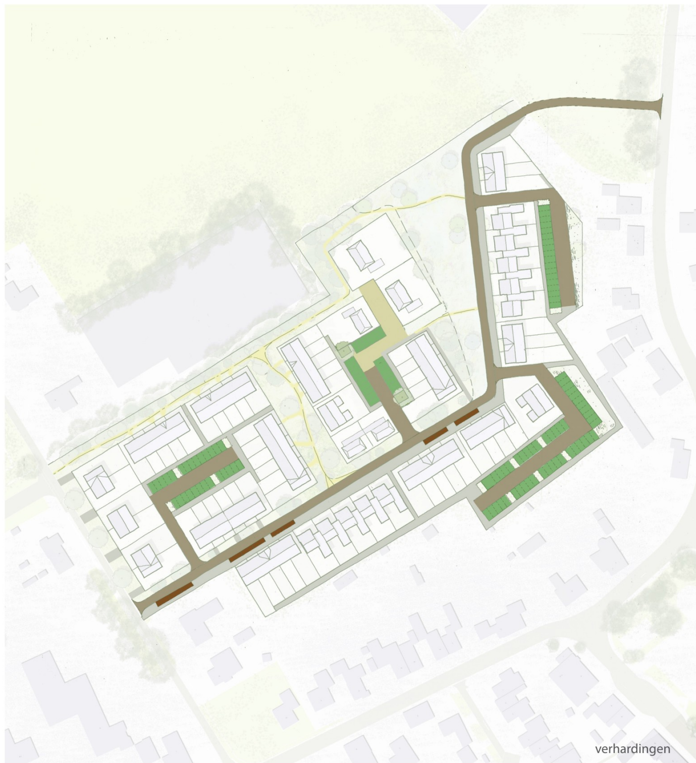
rijloper in keiformaat roodbruin, parkeervakken langs het lint geduid in een donkerdere steen. trottoirs in 30x30 betontegels
