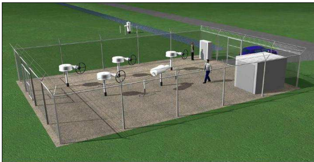
Afbeelding 10: voorbeeld van een afsluiterlocatie
