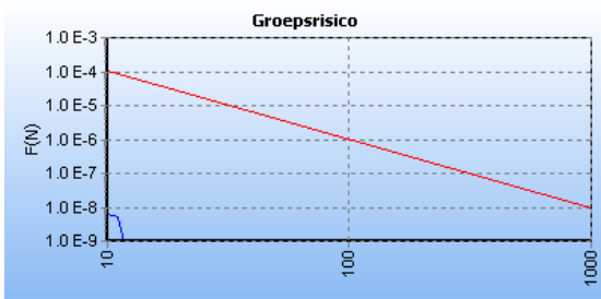
Figuur 16: FN-curve van de kilometer in Figuur 10, voor realisatie van de nieuwbouw. De nieuwbouw beïnvloedt het GR van deze kilometer niet.
