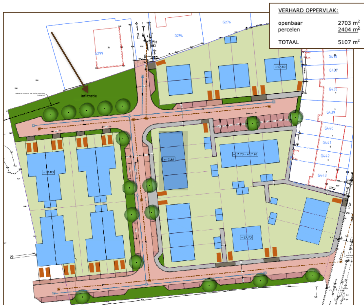
Afbeelding 16: Tekening met kavels en infrastructuur, groen en infiltratie van het hemelwater
