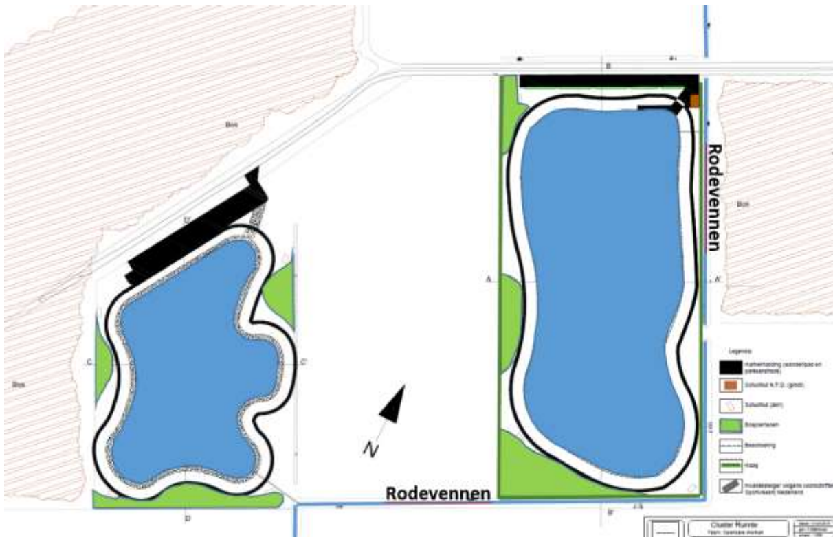
Figuur 2 Planontwerp visvijvers
