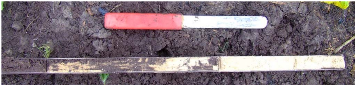
Figuur 13: Foto van boring 24 met een sterk verstoorde overgang tussen de A- en de C-horizont. De B-horizont ontbreekt volledig.
