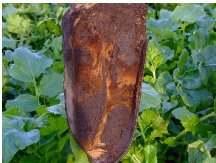
Figuur 15: sterk verstoorde AB-horizont in edelman boor ter plaats van boring 25
