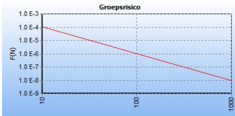
5.7 Figuur 5.7 FN curve voor Z-541-18 van N.V. Nederlandse Gasunie voor de kilometer tussen stationing 980.00 en stationing 1780.00
